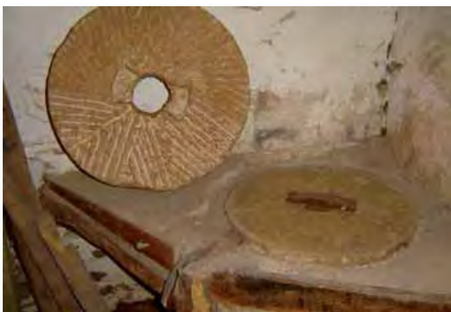
Fig.7. Muela con sistema de cola de milano
