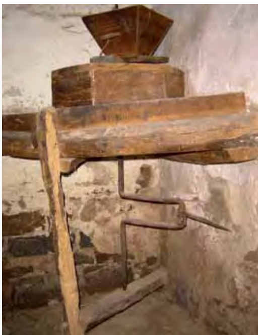
Fig.3. Molino de biela-manivela de Cubo de la Sierra.
